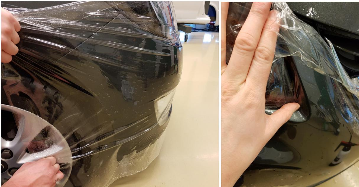
Avery Dennison Pure Defense PU ist sehr anpassungsfähig und damit gut geeignet für die Verklebung auf den konvexen und beidseitig gewölbten Flächen an der vorderen Karosserie. Trotzdem kann es bei tiefen Rillen ratsam sein, einen Schnitt zu setzen, um in diesen Bereichen Luft-/Wassereinschlüsse zu vermeiden. Der Schnitt beeinträchtigt weder Funktionalität noch Haltbarkeit von Avery Dennison Pure Defense PU.
